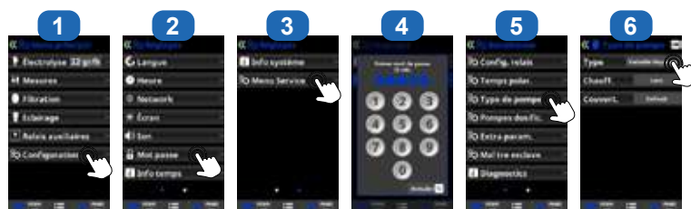
Schéma d'installation d'une pompe à vitesse variable sur l'AquaRite® +
