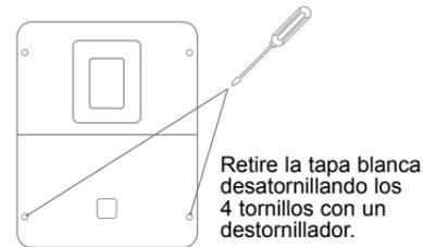
Retire la tapa blanca desatornillando los 4 tornillos con un destornillador.
