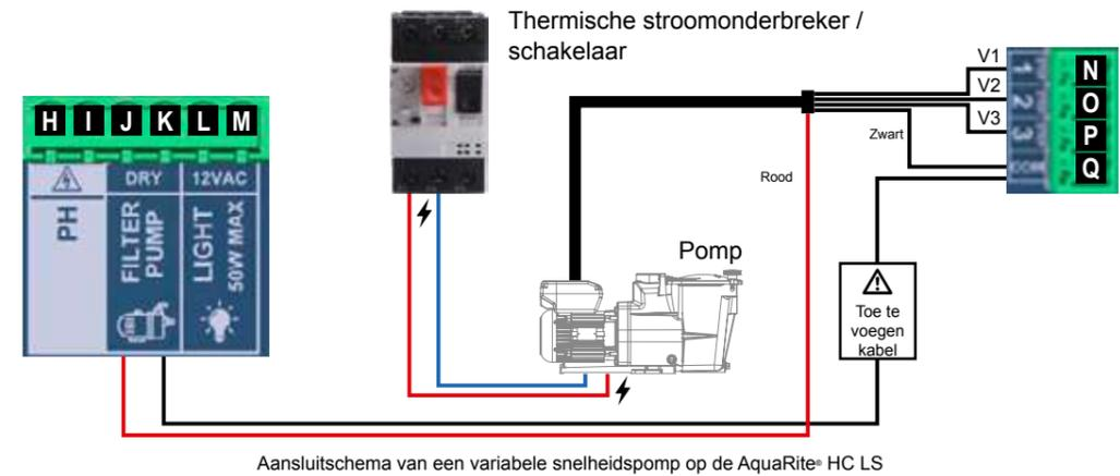
Aansluitschema van een variabele snelheidspomp op de AquaRite® HC LS
