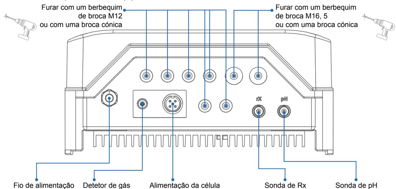
Fio de alimentação Detetor de gás Alimentação da célula Sonda de Rx Sonda de pH
