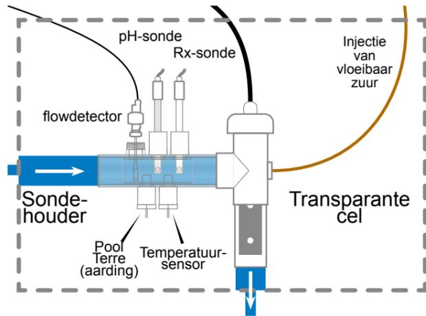
**Installatie en aansluiting van de cel (zie schema):**
