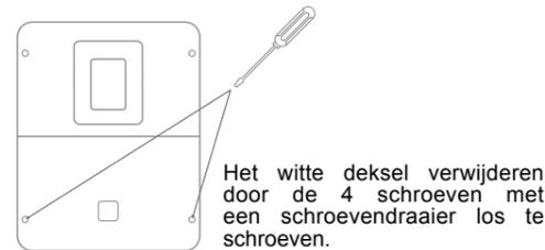
Het witte deksel verwijderen door de 4 schroeven met een schroevendraaier los te schroeven.
