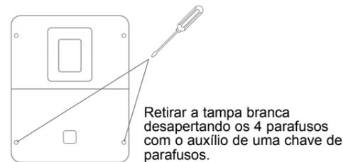
Retirar a tampa branca desapertando os 4 parafusos com o auxílio de uma chave de parafusos.
