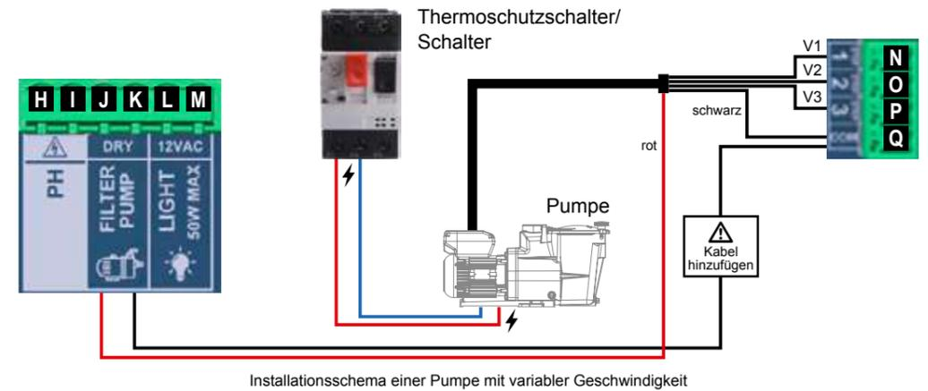
Installationsschema einer Pumpe mit variabler Geschwindigkeit
