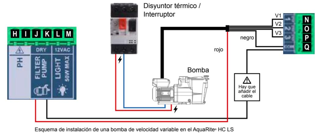
Esquema de instalación de una bomba de velocidad variable en el AquaRite® HC LS
