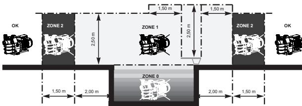
Installera pumpen i ett torrt utrymme med god ventilation. Motorn kräver att luften får cirkulera fritt runt den för naturlig ventilation. Kontrollera regelbundet att inga föremål, löv eller skräp blockerar motorns kylsystem.
