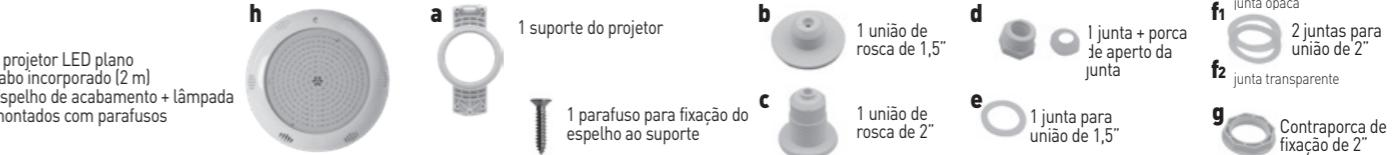
**FIXAÇÃO DO PROJETOR À PAREDE (Série 061611181XXX):**
