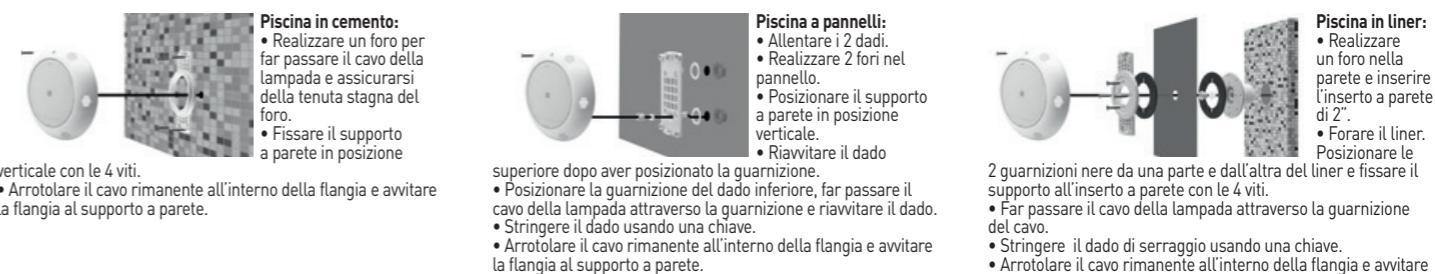
**FISSAGGIO DEL PROIETTORE AL MURO (Serie 061611183XXX):**
