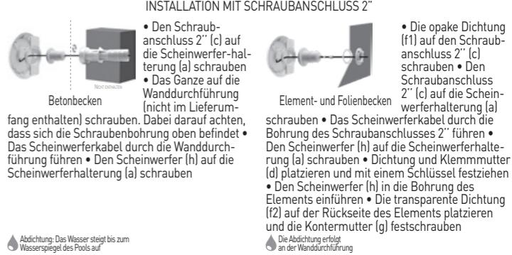
**INSTALLATION MIT SCHRAUBANSCHLUSS 2":**
