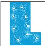
Système de guidage automatique AquaPilot® qui couvre l'ensemble du bassin. Son déplacement en spirales lui permet de ne jamais rester bloqué.
