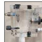
Sonde ampérométrique de mesure du chlore libre
