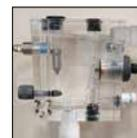
Sonde ampérométrique de mesure du chlore libre
