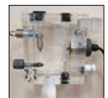
Sonde ampérométrique de mesure du chlore libre
