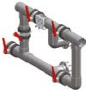
Baterías desmontadas con válvulas sistema Netvitc®
